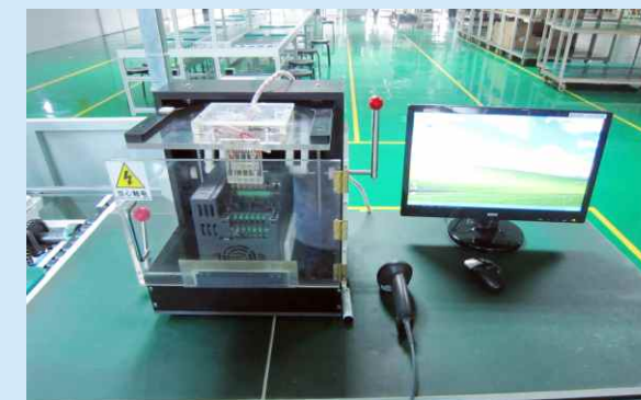
Plataforma automática de pruebas FLASH
